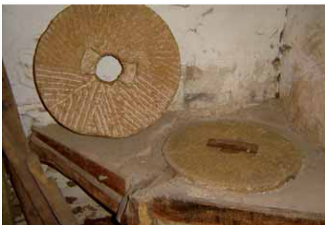
Fig.7. Muela con sistema de cola de milano
